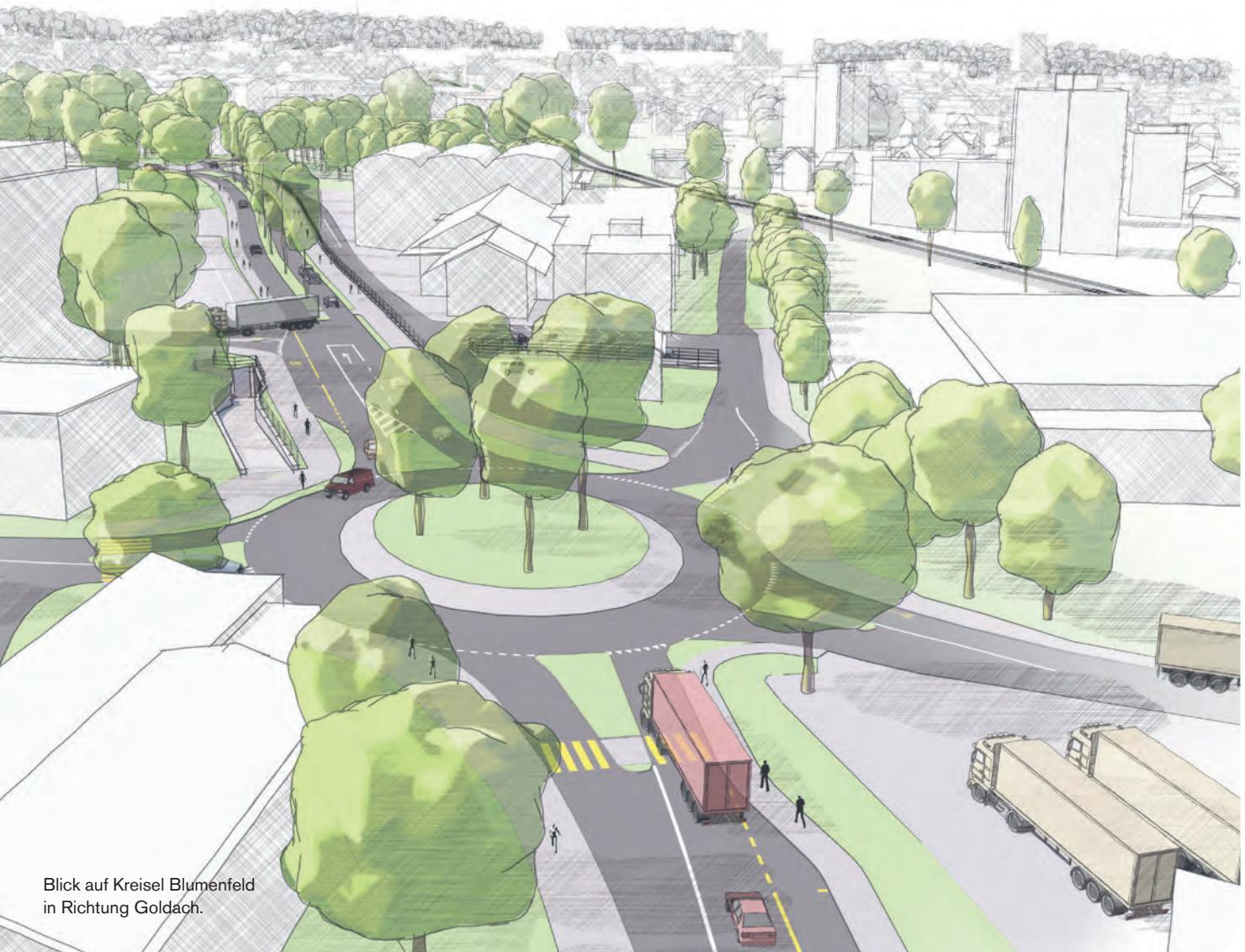
Ab dem Kreisel Blumenfeld wird der Grossteil des Gewerbe- und Industriegebiets erschlossen. Die Verbindung der zwei geteilten Klosterstrasse wird für den Fuss- und Veloverkehr mit einer Unterführung sichergestellt. Der Bahnübergang Klosterstrasse (Künzlerpass) wird geschlossen.
